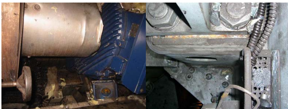
V42发电机底角断裂和主轴承座移位
